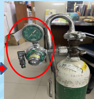
ถังออกซิเจนพร้อมหัว regulator with check valve
