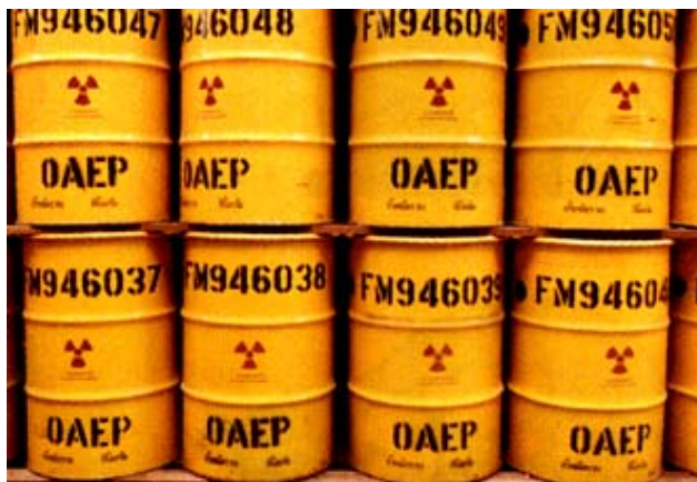
รูปที่ 5.2 แสดงกากกัมมันตรังสีที่รวบรวมแล้วทำให้เข้มข้น (concentration and contain) บรรจุภาชนะแล้ว ภาพจากสำนักงานปรมาณูเพื่อสันติ
