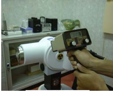
รูปที่ 2.6 แสดงเครื่องวัดรังสีแบบ Survey meter ซึ่งมีน้ำหนัก เบา ความไวสูง ใช้วัดรังสีทั่วไป
