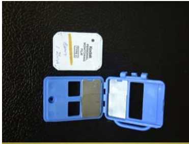
รูปที่ 2.3 แสดงเครื่องวัดรังสีแบบ Film Badge ซึ่งใช้ฟิล์มและ ตลับกรอกรังสี
