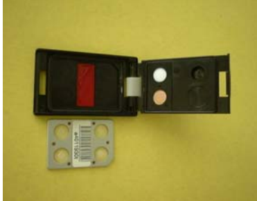
รูปที่ 2.4 แสดงเครื่องวัดรังสีแบบ TLD Badge ซึ่งใช้ผลึก Lithium Fluoride (LiF) เป็นตัวจับรังสี
