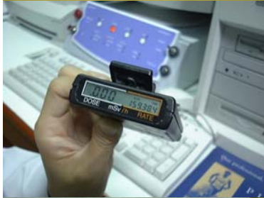
รูปที่ 2.5 แสดงเครื่องวัดรังสีแบบ pocket dosimeter ซึ่งใช้ หัววัดรังสี Geiger Muller detector เป็นตัวจับรังสี สามารถบอก ค่าปริมาณรังสีที่ได้รับได้ทันที
